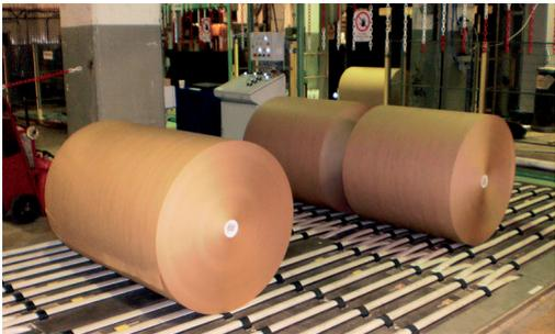
*MoveRoll Rollenförderer zeichnen sich durch hohe Handling-Kapazität aus und sind für Rollen in allen Größen geeignet.*
